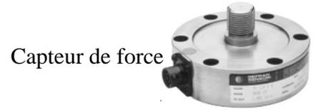
Ce capteur comporte 4 jauges de contrainte identiques montées en pont de Wheatstone (figure ci-contre).
